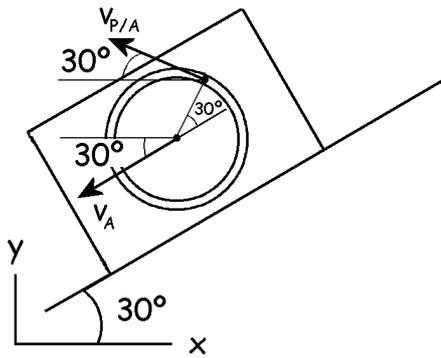
a) Si describimos el movimiento del pasador P respecto del bloque A, tendremos un sistema de referencia en traslación, de modo que la velocidad de P será:
