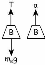
a) Para determinar la velocidad del bloque B necesitamos su aceleración, que será la misma que la del cilindro y la de la plataforma A. Aislamos en primer lugar el bloque B, para el cual:
