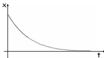
En el amortiguamiento supercrítico o sobreamortiguado ( $\beta > \omega_0$ ) tendremos que la frecuencia  $\omega' = \sqrt{\omega_0^2 - \beta^2}$  es imaginaria, y la solución no viene dada por funciones sinusoidales sino por funciones hiperbólicas que son en esencia exponenciales. El sistema en este caso no efectúa ninguna oscilación y al separarlo de la posición de equilibrio simplemente retorna a ella
