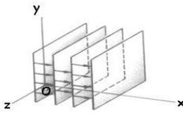
Una noción importante en el concepto de ondas es el denominado frente de ondas, entendiéndose por tal todos los puntos del medio material que tienen el mismo estado de deformación en un instante dado.
