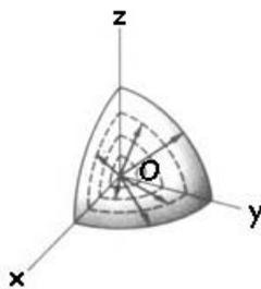
Por último, en las ondas esféricas los frentes de onda son esferas concéntricas. La onda se propaga en todas las direcciones del espacio. Este tipo de onda se generaría en un medio isótropo y homogéneo cuando hay una perturbación puntual. La superficie de una esfera es  $4\pi r^2$ , de modo que la intensidad de las ondas esféricas disminuye con el cuadrado de la distancia:
