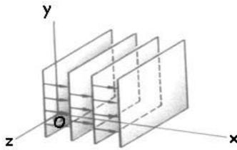
Si el frente de ondas viene dado por planos perpendiculares a un eje, a esta onda la denominamos onda plana. Los frentes de ondas son planos de sección  $S$  constante, de modo que la intensidad que atraviesa cada sección se mantiene constante:
