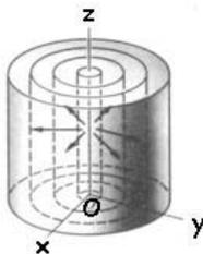
En el caso de ondas cilíndricas los frentes de onda son cilindros coaxiales paralelos a una línea dada. La onda se propaga en todas las direcciones perpendiculares a dicha línea. Este tipo de ondas se generaría en un medio isótropo y homogéneo que contuviera muchas fuentes colocadas en una cierta línea. Puesto que la superficie de un cilindro es  $2\pi rh$  la intensidad de la onda disminuye con la distancia:
