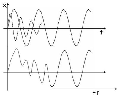
donde  $A$  depende de las características del sistema que oscila ( $\omega_0$ ,  $m$ ), del amortiguamiento ( $\beta$ ) y de la fuerza impulsora ( $F_0$ ,  $\omega$ ). Esta solución indica un movimiento oscilatorio sinusoidal de frecuencia  $\omega$ .
