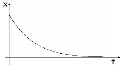
c) Por último, si  $\beta > \omega_0$  el amortiguamiento es supercrítico o se dice que el movimiento es sobreamortiguado. La frecuencia  $\omega'$  sería imaginaria, y la solución no tiene funciones sinusoidales, sino hiperbólicas (en esencia, exponenciales):
