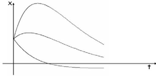
b) Si  $\beta = \omega_0$  el amortiguamiento es crítico, la frecuencia  $\omega'$  es nula y la solución no es oscilatoria:
