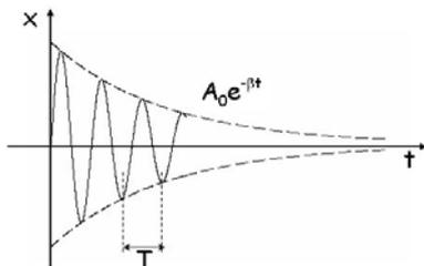
con  $\omega' = \sqrt{\omega_0^2 - \beta^2}$ . ( $A_0$  y  $\varphi$  son función de las condiciones iniciales  $\{x_0, v_0\}$ ). La amplitud no es constante y ya no es un movimiento armónico simple, sino que dicha amplitud decrece exponencialmente con el tiempo:
