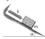
Supongamos ahora el caso de un cuerpo sobre un plano inclinado con rozamiento y sujeto a un muelle en la parte superior, tal como aparece en la figura. Al desplazarse en el plano inclinado entre dos posiciones A y B el teorema que acabamos de demostrar nos dará la expresión:
