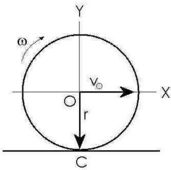
a) Supongamos un cuerpo circular de radio  $r$  que rueda sin deslizar. Por la condición de rodadura pura tenemos que el centro geométrico  $O$  tiene una velocidad paralela al suelo y que vale:
