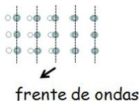
b) Se denomina superficie o frente de ondas al lugar geométrico determinado por los puntos del medio que son alcanzados simultáneamente por la perturbación y que, en consecuencia, en cualquier instante dado están en el mismo estado o fase de la perturbación.
