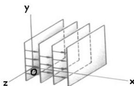
Los frentes de onda pueden tener formas muy diversas. Si las ondas se propagan en una sola dirección, los frentes de onda estarán constituidos por planos paralelos (ondas planas). En un instante dado, las condiciones son idénticas en todos los puntos de un plano cualquiera perpendicular a la dirección de propagación. Los frentes de onda son planos y los rayos son rectas paralelas.
