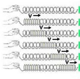
Un ejemplo de ondas longitudinales son las que se propagan en un muelle. Supongamos que súbitamente desplazamos el extremo del muelle hacia la derecha. Las partículas del resorte son obligadas a desplazarse hacia adelante, y la perturbación progresa a lo largo del resorte con una velocidad constante. El movimiento de cada partícula del resorte es hacia adelante, paralelo a la dirección en que se propaga la perturbación. Esta onda es longitudinal.
