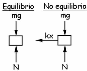
Puesto que el sistema se mueve en un plano horizontal y no existe rozamiento, en la posición de equilibrio el resorte estará sin deformar. Si desplazamos el resorte una cantidad  $x$  hacia la derecha y permitimos el movimiento, tendremos el diagrama que aparece en la figura. Aplicando la segunda ley de Newton a la situación fuera del equilibrio:
