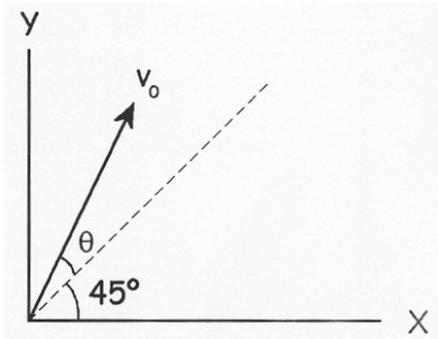
Supongamos en principio que lanzamos el proyectil con una velocidad  $v_0$  que forma un ángulo con el eje X de  $(45^\circ + \theta)$ . Tendremos entonces que las velocidades iniciales en los dos ejes son:
