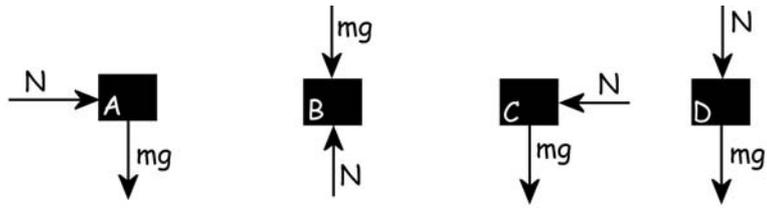
Si el bloque no pierde el contacto con la pista en ningún momento, estará sometido siempre a dos fuerzas, el peso y la acción de la pista, que por no tener rozamiento será normal, es decir, perpendicular a la tangente. Así pues, los diagramas de fuerza en los cuatro puntos que se indican son los que aparecen en la figura.
