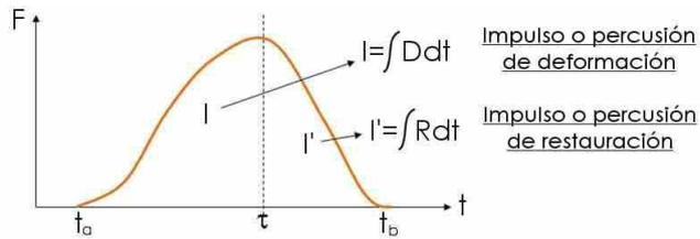
En la figura se muestra una posible forma de variación de la fuerza impulsiva ( $D$  o  $R$ ) que actúa durante el intervalo de tiempo  $t_a \leq t \leq t_b$  que dura la colisión. El área encerrada entre la curva  $F(t)$  y el eje de abscisas representa el impulso o percusión total
