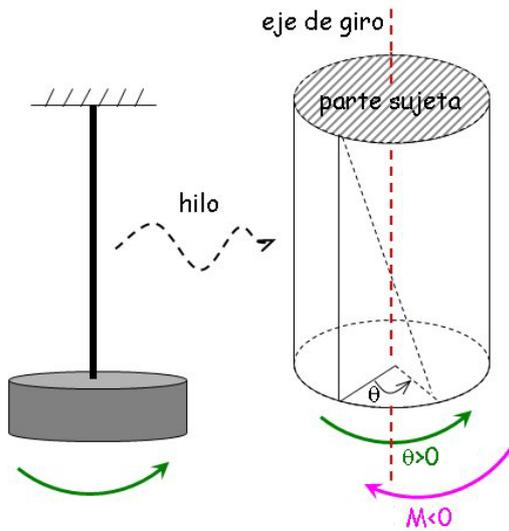
Un péndulo de torsión consiste en una masa unida a un hilo que está girado (torsionado). Debido a la torsión el hilo gira y se produce un movimiento oscilatorio.
