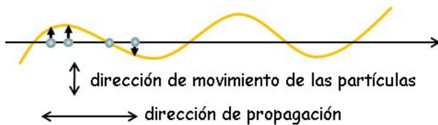
En las ondas transversales la dirección de propagación es perpendicular a la dirección del movimiento. Un ejemplo típico es la vibración de una cuerda.
