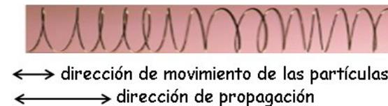
En las ondas longitudinales la dirección de propagación es paralela a la dirección del movimiento de las partículas. Ejemplos de este tipo de ondas son las ondas longitudinales en un muelle o el sonido.
