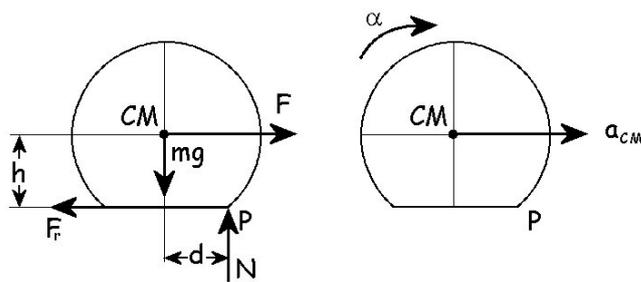
En un caso real la rueda (o el suelo) sí presentan deformación. La parte de la rueda en contacto con el suelo estará aplanada, y la normal no se encuentra debajo del centro de masas. Así, el movimiento se produce por pivotamiento en el punto P (último punto de contacto), con lo que la normal está desplazada hacia la
