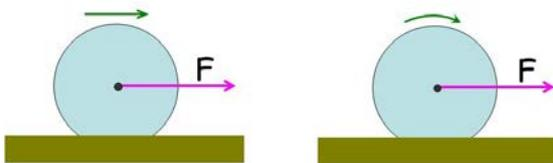
Fijémonos ahora en la diferencia entre la rodadura (derecha) y el deslizamiento (izquierda). En el caso del deslizamiento:
