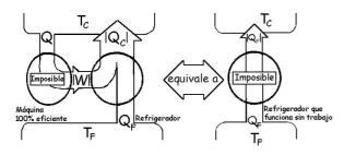
Supongamos que se pudiera construir una máquina perfecta que convirtiera el calor absorbido del foco caliente enteramente en trabajo (violando, por consiguiente, la segunda ley de la termodinámica según el planteamiento de Kelvin-Planck). Esta máquina acoplada a un refrigerador que utilizara dicho trabajo para extraer calor del foco frío y
