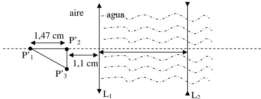
Podemos verificar del dibujo que el nuevo triángulo es también rectángulo (es así porque estamos en óptica paraxial y estamos considerando objetos próximos al eje óptico). El área de este triángulo es:
