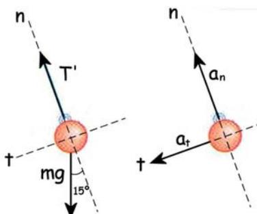
Para la aceleración tangencial hacemos el diagrama de sólido libre de la bola cuando la cuerda forma un ángulo de  $15^{\circ}$  con la vertical. Tendremos lo que aparece en la figura, donde denominaremos  $T'$  a la nueva tensión para no confundirla con la anterior. Aplicando la segunda ley de Newton:
