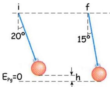
c) Para determinar la velocidad de la bola podemos aplicar el teorema de conservación de la energía mecánica entre el extremo de la oscilación (i), donde la velocidad de la bola es nula, y el punto en el cual la cuerda forma un ángulo de  $15^{\circ}$  con la vertical (f). Así, tendremos:
