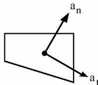
Tomaremos como sistema de ejes las direcciones normal y tangencial. Si aplicamos las ecuaciones de la dinámica del sólido rígido tenemos:
