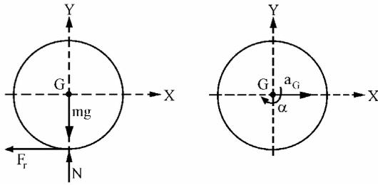
Aislamos la bola y dibujamos el diagrama del sólido libre cuando llega al suelo. Aplicamos las ecuaciones de la dinámica del sólido rígido:
