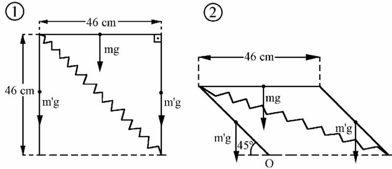
Consideramos las patas como varillas delgadas. Evidentemente el movimiento de la plataforma es una traslación ya que siempre permanece paralela al suelo. Vamos a considerar la situación 1 cuando  $\theta=0^\circ$  y la 2 cuando  $\theta=45^\circ$ . El trabajo del par aplicado a la pata más la energía mecánica en la situación 1 es igual a la energía mecánica en la situación 2.
