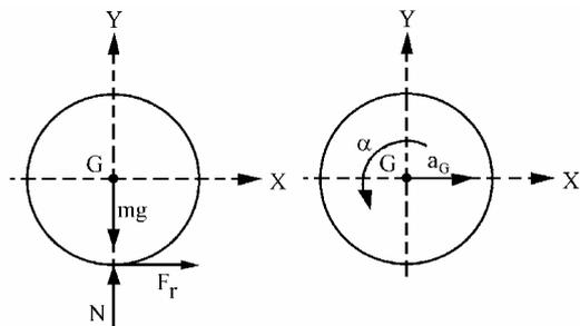
El diagrama del sólido libre respecto a un sistema inercial será el que aparece en la figura (ver página siguiente). Aplicamos las ecuaciones del movimiento del sólido rígido:
