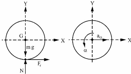
Aislamos el cilindro y dibujamos el diagrama de sólido libre correspondiente. Aplicamos las ecuaciones de la dinámica del sólido rígido:
