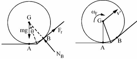
Un instante después, cuando el disco apoya completamente en B y empieza a rodar hacia arriba del plano inclinado:
