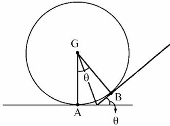
Llegará un momento en que el disco, en su movimiento, entre en contacto con el plano inclinado. Esto sucederá cuando la bisectriz del ángulo formado por la horizontal y el plano inclinado pase por el centro del disco.
