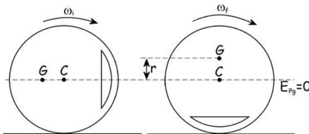
c) Como el rozamiento a la rodadura no disipa energía y la normal es perpendicular al desplazamiento (por tanto no realiza trabajo), la energía mecánica del sistema debe conservarse. Eso implica que la suma de las energías potencial y cinética debe ser constante. Por tanto, la velocidad será mínima cuando la energía cinética sea mínima,
