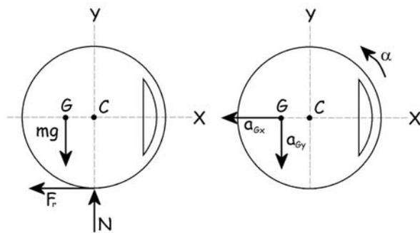
En cuanto a fuerzas, tendremos el peso en el centro de masas, y las reacciones del suelo, que serán la normal y la fuerza de rozamiento. La fuerza de rozamiento tiene que ir hacia la izquierda, ya que hemos dicho que el movimiento es decelerado, de modo que la aceleración tiene sentido contrario a la velocidad (hacia la izquierda). Aplicamos a continuación la segunda ley de Newton:
