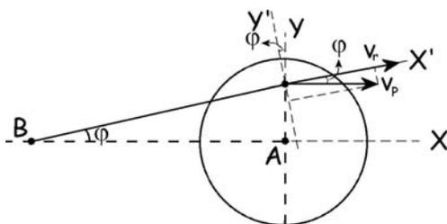
Ahora vamos a poner la velocidad del punto P en función de B, para así tener la velocidad relativa. Tomaremos unos nuevos ejes X' e Y', el eje X' en la dirección BP y sentido positivo el de crecimiento de dicha distancia y el Y' perpendicular al anterior y sentido positivo el de crecimiento de  $\varphi$ . Tendremos pues ahora:
