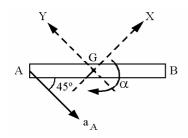
Para plantear las ecuaciones de la dinámica es necesario calcular la aceleración del centro de masas. De la cinemática del sólido rígido:
