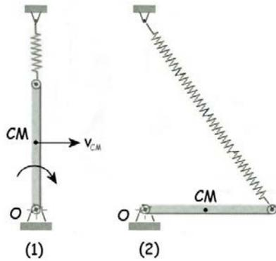
a) Vamos a aplicar el teorema de las fuerzas vivas, entre la posición inicial (1), cuando  $\theta=0^\circ$  y la velocidad es  $\omega$ , y la posición final (2), cuando  $\theta=90^\circ$  y la velocidad es justamente nula. Tendremos en esquema lo que aparece en la figura. Tendremos:
