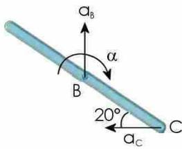
a) Puesto que vamos a aplicar la segunda ley de Newton, vamos a determinar la aceleración del centro de masas de la barra, que está en el punto B, relacionándola con la aceleración angular, para así tener una incógnita menos. Para ello, lo ponemos en función del punto C, sabiendo que B se mueve verticalmente hacia arriba y C se mueve horizontalmente hacia la izquierda.
