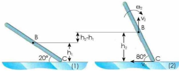
b) Puesto que en este tipo de problemas la aceleración no suele ser constante, para determinar la velocidad angular de la barra cuando  $\theta=80^\circ$  aplicamos el teorema de las fuerzas vivas. Llamamos posición 1 cuando  $\theta=20^\circ$  y posición 2 cuando  $\theta=80^\circ$ , de modo que tendremos:
