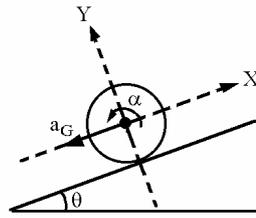
A) Aislamos la rueda y dibujamos el diagrama del sólido libre. El centro de masa de la rueda, que coincide con su centro geométrico, tiene un movimiento de traslación rectilíneo en la dirección paralela a la del plano
