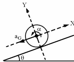
B) Hacemos el diagrama de la rueda en el caso B. Igual que antes la aceleración del centro de masa (que coincide con el centro geométrico) es paralela al plano inclinado ya que dicho punto realiza un movimiento rectilíneo. Aplicando las ecuaciones de la dinámica:
