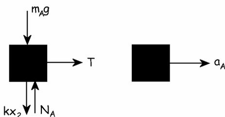
sólido libre de cada uno de los bloques. En cuanto al bloque A tendremos lo que aparece en la figura. Aplicando la segunda ley del Newton al eje X:
