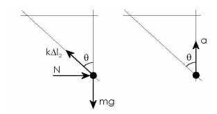
b) Ahora vamos a hacer el diagrama de sólido libre de la masa en el punto (2). En cuanto a fuerzas, tendremos el peso, vertical y hacia abajo, la reacción del resorte, de tensión, y la normal, cuyo sentido puede inferirse de la condición de fuerzas nulas en el eje X (ya que el movimiento es unidimensional y vertical). Respecto a la aceleración, como el movimiento es unidimensional será vertical, y su sentido
