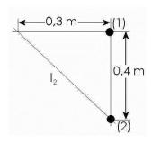
a) Vamos a aplicar el teorema de las fuerzas vivas entre la posición inicial (1), cuando la masa parte del reposo en b=0 y la posición final (2), cuando la barra llega a b=400 mm y evidentemente se detiene para invertir el sentido del movimiento. Obviamente, si el punto 2 implica una distancia  $b_{m\acute{a}x}$  es el punto más bajo de la trayectoria y puesto que ésta es una línea recta debe detenerse. Así, tendremos:
