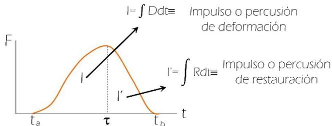
En la figura se muestra una posible forma de variación de la fuerza impulsiva ( $D$  o  $R$ ) que actúa durante el intervalo de tiempo  $t_a \leq t \leq t_b$  que dura la colisión. El área encerrada entre la curva  $F(t)$  y el eje de abscisas representa el impulso o percusión total producida por dicha fuerza. Es conveniente descomponer
