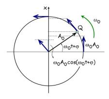
En cuanto a la velocidad, para un movimiento circular y uniforme tendremos que es tangente a la circunferencia y sentido el de avance del móvil, y en módulo es igual a la velocidad angular por el radio, en nuestro caso:
