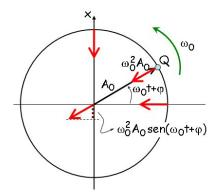
tangencial es nula, ya que el módulo de la velocidad permanece constante, y por tanto tenemos sólo la componente normal, que nos da la variación de la dirección de la velocidad en el tiempo, y que vale:  $a_n = \frac{v^2}{r} = \frac{(A_0 \omega_0)^2}{A_0} = A_0 \omega_0^2$
