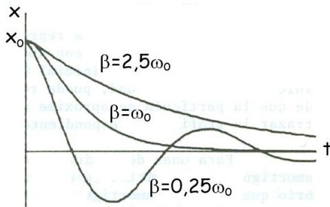
una vez a lo sumo. Para unas condiciones iniciales dadas  $(x_0, v_0)$ , cuanto mayor sea el amortiguamiento más tiempo empleará el sistema en quedar en reposo en la posición de equilibrio. En la figura hemos representado gráficamente las curvas de elongación-tiempo correspondientes a un oscilador infraamortiguado, un oscilador con amortiguamiento crítico y un oscilador sobreamortiguado, para las mismas condiciones iniciales  $x_0 \neq 0, v_0 = 0$ .
