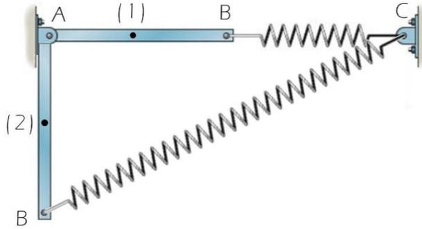
Para calcular la constante del resorte aplicamos el teorema de las fuerzas vivas entre la situación inicial, con la barra horizontal (1) y la situación final, con la barra vertical (2). En ambos casos la energía cinética será nula ya que la barra parte del reposo y se detiene en la vertical. Tendremos lo que aparece en la figura, siendo el alargamiento del resorte en la posición 1 nula y en la posición 2:
