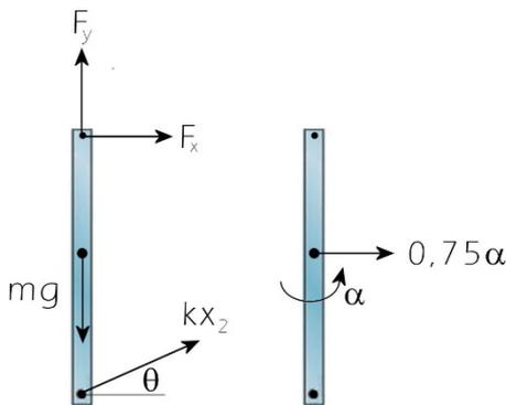
Tendremos en cuanto a fuerzas el peso, la reacción del pasador y la del resorte. En cuanto a aceleraciones, tendremos la aceleración angular, de sentido antihorario, ya que la barra comenzará a volver hacia arriba, y la aceleración lineal del centro de masas. Como el centro de masas realiza un movimiento circular de 0,75 m de radio, sus componentes, en intrínsecas, serán:
