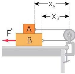
a) Llamamos  $x_A$  a la posición en cada instante del bloque A, y  $x_B$  a la posición en cada instante del bloque B (ver figura). Teniendo en cuenta el sentido del movimiento de cada bloque, tendremos:
