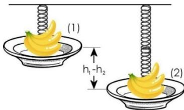
Lo podríamos haber hecho también por energías. Partimos del punto 1, en que el resorte tiene un alargamiento  $x_1 = 1 \text{ cm} = 0,01 \text{ m}$  y el sistema parte del reposo, y el sistema baja hasta la posición 2, donde llamamos  $x_2$  al alargamiento del resorte y donde la velocidad será nula, puesto que es el punto de máxima elongación (amplitud). Nos quedaría lo que aparece en la figura, y aplicando el teorema del trabajo y la energía cinética:
