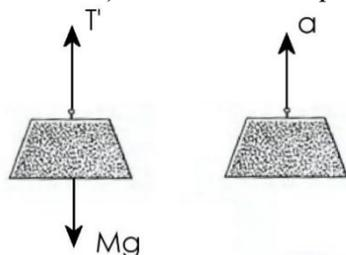
Comenzamos con el bloque, que asciende verticalmente. Aplicamos la segunda ley de Newton al eje vertical. Tendremos:
