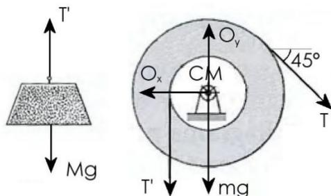
a) En el caso del bloque tendremos su peso, vertical y hacia abajo, y la tensión en la cuerda, vertical y hacia arriba. En el caso de los tambores tendremos el peso, vertical y hacia abajo, las dos tensiones de las cuerdas, en la dirección de la cuerda y hacia fuera del sólido, y las reacciones en el pasador central. Nos quedará por tanto lo que aparece en la figura.
