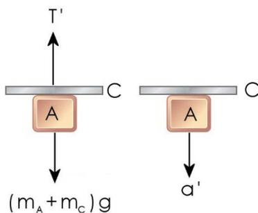
También podríamos hacerlo por fuerzas. Después del choque hacemos los diagramas de sólido libre de los bloques, teniendo en cuenta que los bloques A y C se moverán hacia arriba con una aceleración  $a'$  mientras que el bloque B se moverá hacia abajo con esa misma aceleración, y que además el sistema está ahora decelerando. Además, ahora a la tensión la denominaremos  $T'$ . Tendremos pues que para los bloques A y C:
