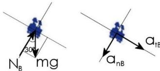
Para la aceleración tangencial realizamos el diagrama de fuerzas de la vagoneta en el punto B y aplicando la segunda ley de Newton:
