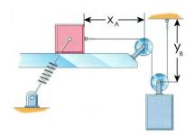
a) Marcaremos con el subíndice A al bloque de 2 kg y con el subíndice B al bloque de 3 kg. En primer lugar, vamos a ver la relación entre las velocidades y aceleraciones de los dos bloques. Marcamos como x<sub>A</sub> la posición en cada instante del bloque A y como y<sub>B</sub> la posición en cada instante del bloque B, todo ello respecto de un origen fijo. Así, tendremos que:
