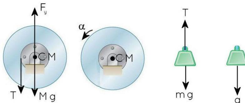
Y tendremos dos ecuaciones, la de rotación de la polea y la de traslación de la masa ( $m = P/g = 720/9,8 = 73,469 \text{ kg}$ ). De la rotación de la polea:
