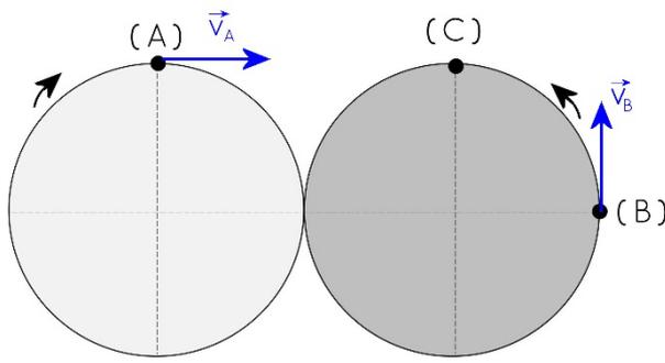
a) Los puntos (A) y (B) tienen movimientos curvilíneos (circulares) de modo que lo más cómodo son las coordenadas intrínsecas. En el caso de la velocidad, para cualquiera de los dos casos la velocidad lineal es la angular por el radio (en módulo), mientras que, en dirección tangente a la trayectoria y sentido el de avance del móvil. Tenemos por tanto:
