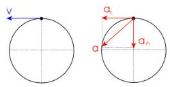
bii) Para representar los vectores, dibujamos la trayectoria, una circunferencia de radio r=2,5 m. Suponemos que se recorre en sentido antihorario. La velocidad será tangente a la trayectoria y sentido el de avance del móvil; la aceleración tangencial tendrá la misma dirección y sentido que la velocidad, ya que el móvil aumenta su velocidad; la aceleración normal tiene la dirección del radio de curvatura y apunta hacia
