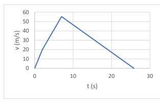
Ahora dibujamos la gráfica biii) velocidad-tiempo. Tenemos tres tramos, todos ellos de movimiento rectilíneo uniformemente acelerado, los dos primeros aceleración positiva v el último con aceleración negativa. Por tanto, la gráfica velocidad tiempo tendré dos rectas de pendiente positiva y una de pendiente negativa. Los límites de cada tramo serán (los obtenemos de los apartados anteriores):
